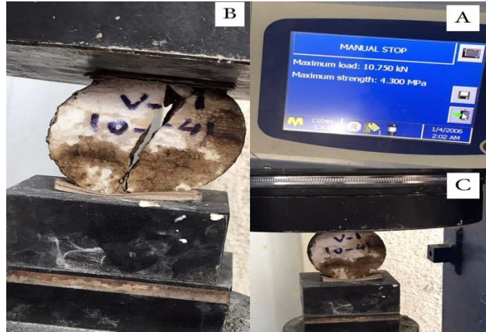
لوحة (3) توضح عملية فحص المقاومة الشدية لصخور تكوين الفرات في منطقة الدراسة
