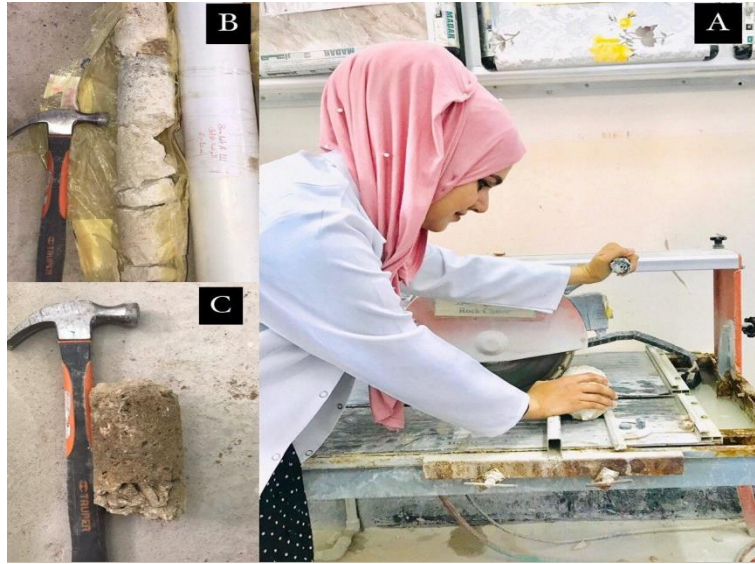
لوحة (1) توضح عملية تحضير النماذج للفحوصات الميكانيكية
